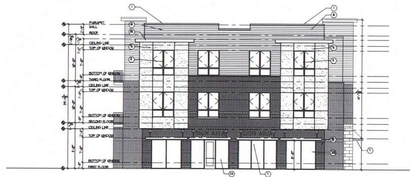
2 WEST ELEVATION SCALE: 1/8" = 1'-0"
