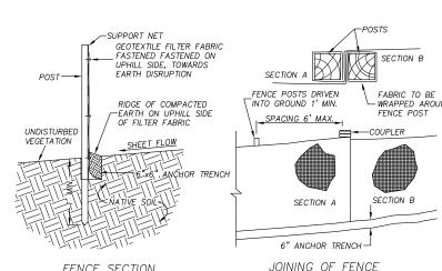
JOINING OF FENCE FABRIC FILTER FENCE DETAIL
