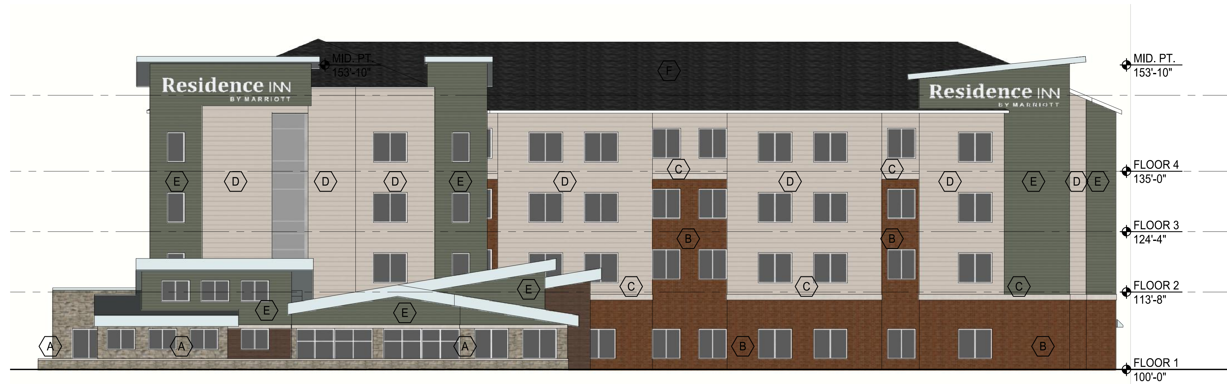
2 NORTH ELEVATION A-301 A-301 SCALE: 3/8" = 1'-0"
